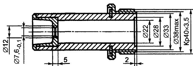
Данные устройства, имитирующего фильтр: масса 300 г, равномерно распределенная по всей длине; сопротивление потоку воздуха 1 кПа при расходе постоянного потока воздуха 95 дм<sup>3</sup>/мин; общая длина 96 мм
