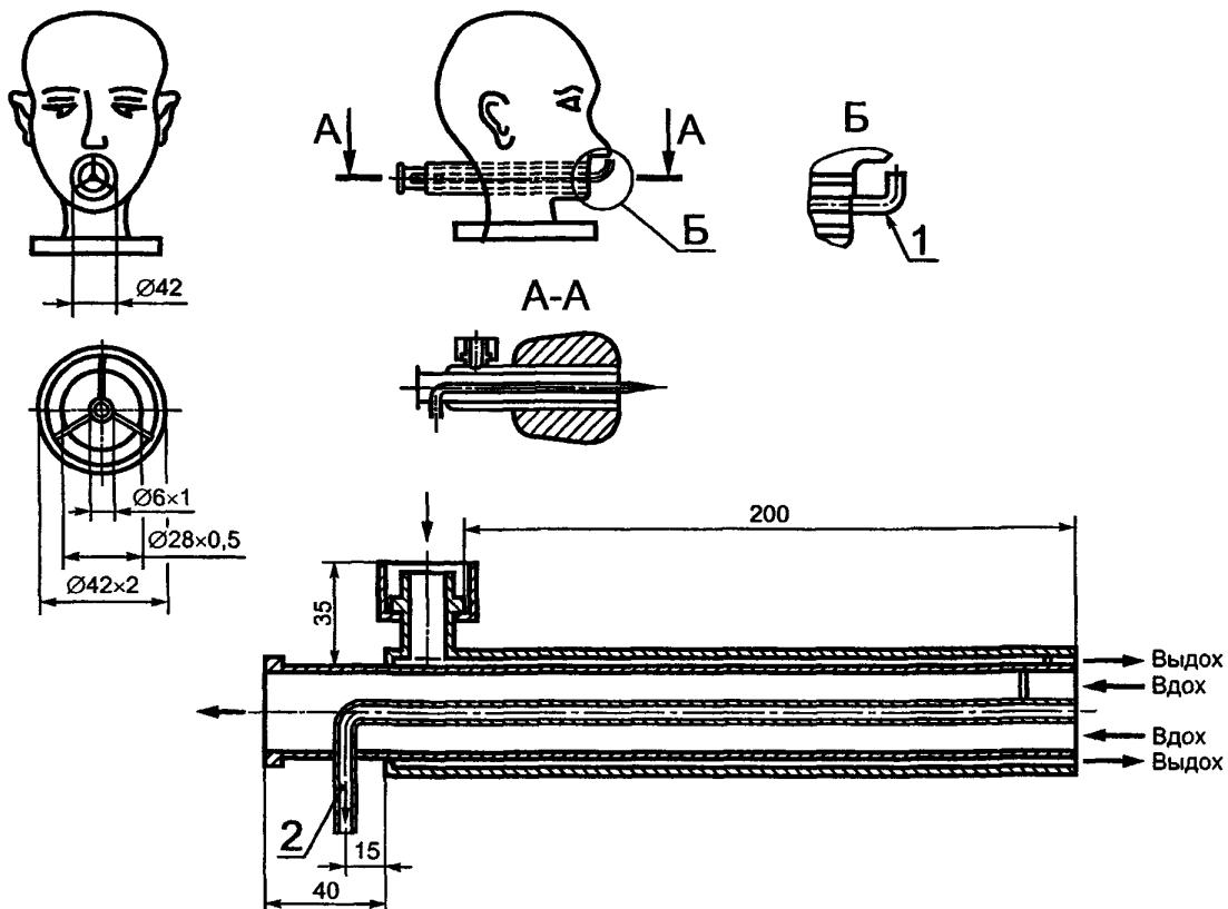
1 — втулка для измерения сопротивления воздушному потоку; 2 — измерение СО<sub>2</sub> (на вдохе)
